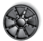
敲打後塑膠支撐部 (8個支撐塊變型， 貼合於螺絲柱頭上)
