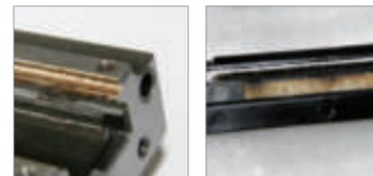
潤滑油乾涸殘留物 上儲油塊破損
