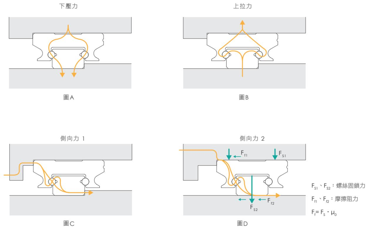
由圖A~圖D三個圖示可看出，在承受向上、向下及側向負載時，力流會分散至兩列滾珠傳遞。
