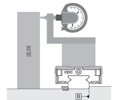
$$W_2 \text{ 平行運行精度 } //P + \text{ 滑軌安裝直度 } \square B$$
