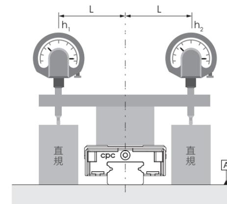
$$H \text{ 平行運行精度 } //P + \text{ 基面平面度 } \square A = |h_1 - h_2|_{\text{total length}}$$
