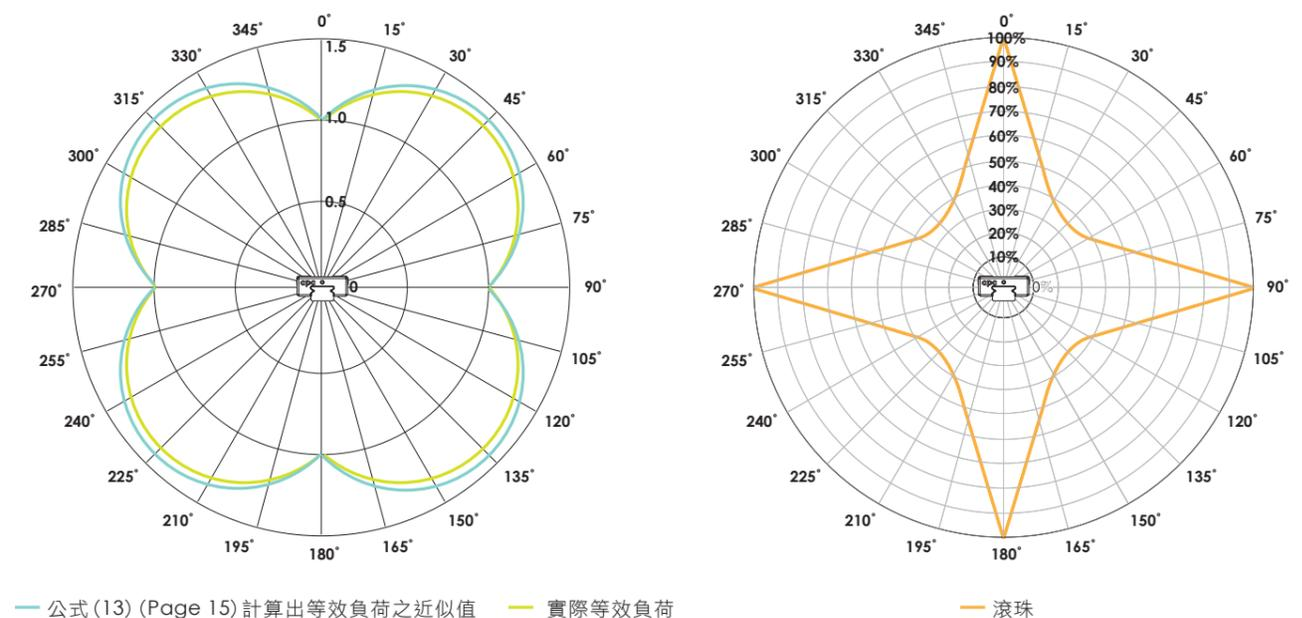
下圖為公式(14)計算之等效負荷近似值與實際等效負荷的比較圖，範例使用MR15MN之線性滑軌在承受一固定下壓力而扭矩逐漸增加的情況。左圖為 $M_x$ 方向的扭矩，右圖為 $M_{p/y}$ 方向的扭矩。
